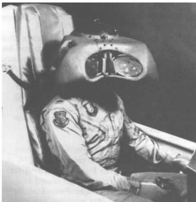
Figura 2: Piloto usando o capacete do projeto “Super Cockpit” de Tom Furness.
